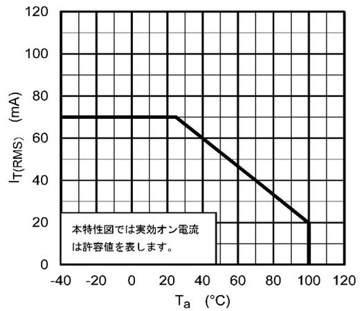
図 12.2  $I_T(\text{RMS}) - T_a$
