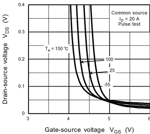
Fig. 8.5  $V_{DS} - V_{GS}$
