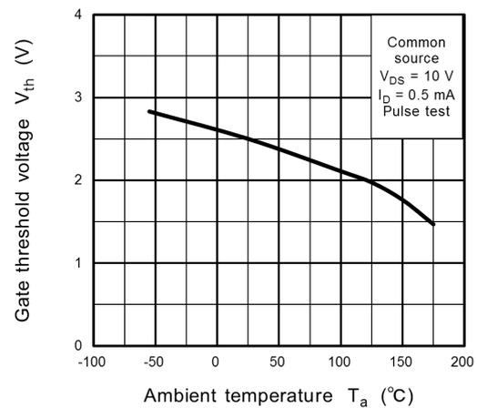
**Fig. 8.12  $V_{th} - T_a$**
