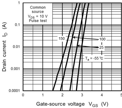
**Fig. 8.7  $I_D - V_{GS}$**
