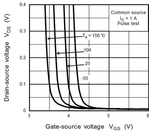
Fig. 8.6  $V_{DS} - V_{GS}$
