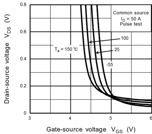
Fig. 8.4  $V_{DS} - V_{GS}$
