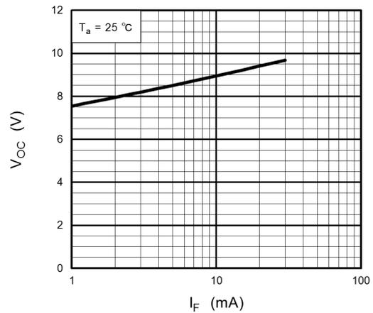
図 12.4  $V_{OC} - I_F$
