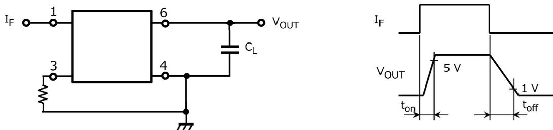
図 11.1 スイッチング時間測定回路, 波形
