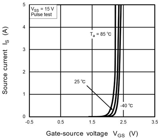
**Fig. 9.3  $I_S - V_{GS}$**
