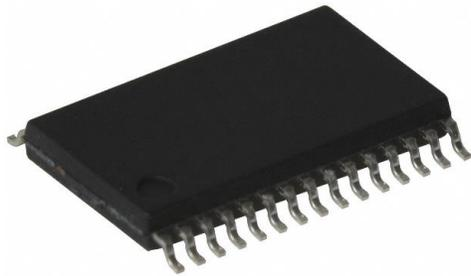
Package: SSOP30-P-300-0.65 (10.2 x 7.6 x 1.6 mm)
