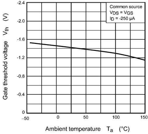
Fig. 8.7  $V_{th} - T_a$
