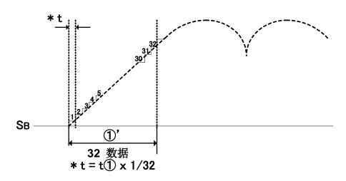
同时,在位置检测信号的各过零点时序调制波的相对齐被完成.在每 60°电角上,调制波被复位与位置检测信号(霍尔放大器输出信号)的上或下缘同步.
