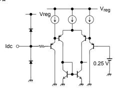
过电流限制电路参考电压变为高于 0.25 V (typ.)时, 所有外部附属的上侧功率 FET 关闭.
