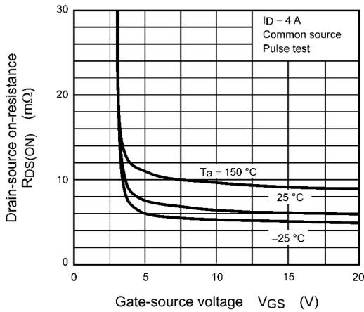
**Fig. 7.3**  $R_{DS(ON)} - V_{GS}$
