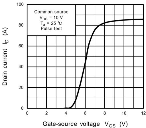
**Fig. 8.3**  $I_D - V_{GS}$
