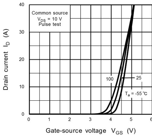
Fig. 8.3  $I_D - V_{GS}$
