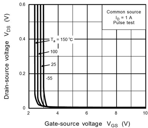
**Fig. 8.6  $V_{DS} - V_{GS}$**
