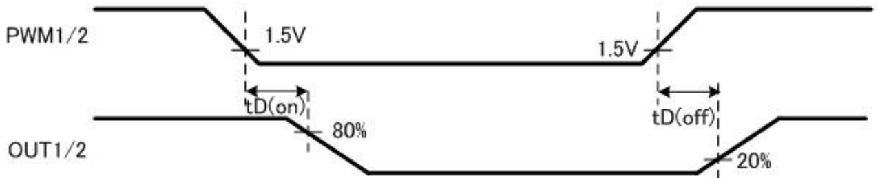
図 10.2 ドライバー出力遅延時間
